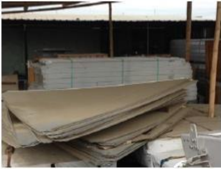
Almacenamiento incorrecto de los paneles del domo
